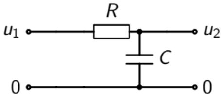
Impedance RC článku:  $Z_{RC} = R + \frac{1}{j\omega C} = R - \frac{j}{\omega C}$
