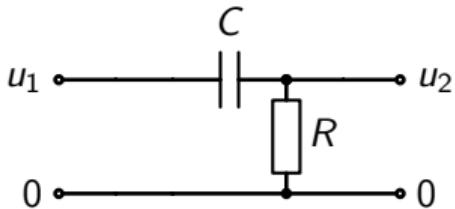
Impedance RC článku:  $Z_{RC} = R + \frac{1}{j\omega C} = R - \frac{j}{\omega C}$
