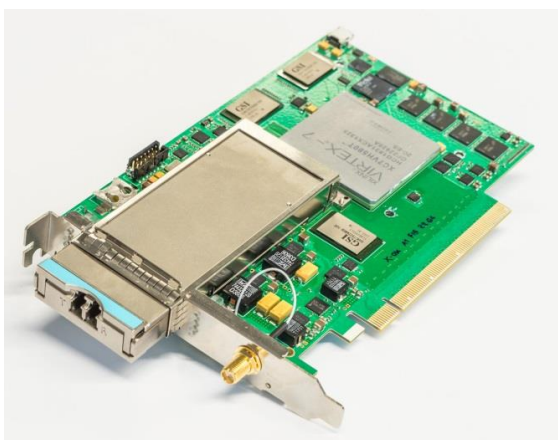
Obr. 1: akcelerační karta COMBO 100G s FPGA Virtex-7
