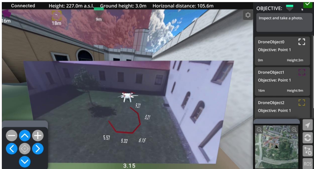
Obr. 1: Ukázka z testovacího letu experimentální mobilní platformou 1 . Pilotu je přenášěn živý obraz z kamery dronu, informace o výšce (nadmořská, nad zemí) a rovněž mu jsou zobrazovány vizuální prvky důležité pro splnění mise (označení cíle, vzdálenosti k cíli, ostatní drony podílející se na misi, vzdálenosti k překážkám atd.)
