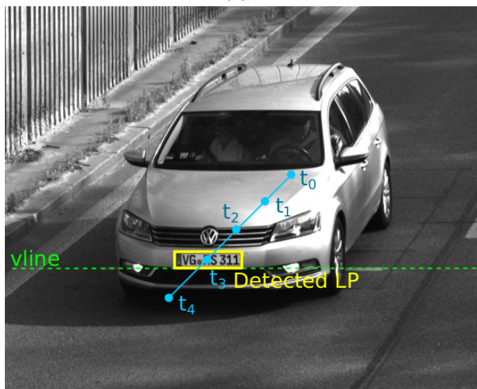
Obrázek 2: Ilustrace obrazu z kamery s naznačenými metadaty - detekcí značky, její trajektorií a virtuální čarou, jejíž překročení vyvolalo událost.
