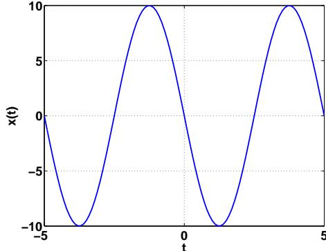
$$\begin{array}{c|c|c|c} \text{A} & \text{B} & \text{C} & \text{D} \\ c_1 = 5e^{j\frac{\pi}{2}}, & c_1 = 5e^{-j\frac{\pi}{2}}, & c_1 = 2e^{-j\frac{\pi}{2}}, & \text{nekonečně mnoho nenulových} \\ c_{-1} = 5e^{-j\frac{\pi}{2}} & c_{-1} = 5e^{j\frac{\pi}{2}} & c_2 = 1e^{j\frac{\pi}{2}}, & \text{koeficientů F}\bar{R} \\ & & c_{-2} = 1e^{-j\frac{\pi}{2}} & \end{array}$$
