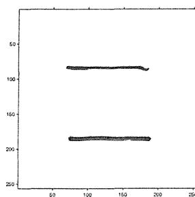
**Příklad 20** Obrázek o rozměrech  $256 \times 256$  obsahuje polovinu pixelů s hodnotou 100 a polovinu pixelů s hodnotou 200. Určete, jaký je poměr signálu k šumu při kvantování tohoto obrázku jedním bitem na pixel, pokud mají kvantovací hladiny hodnoty 110 a 220 a kvantuje se standardně zaokrouhlováním na nejbližší kvantovací hladinu.
