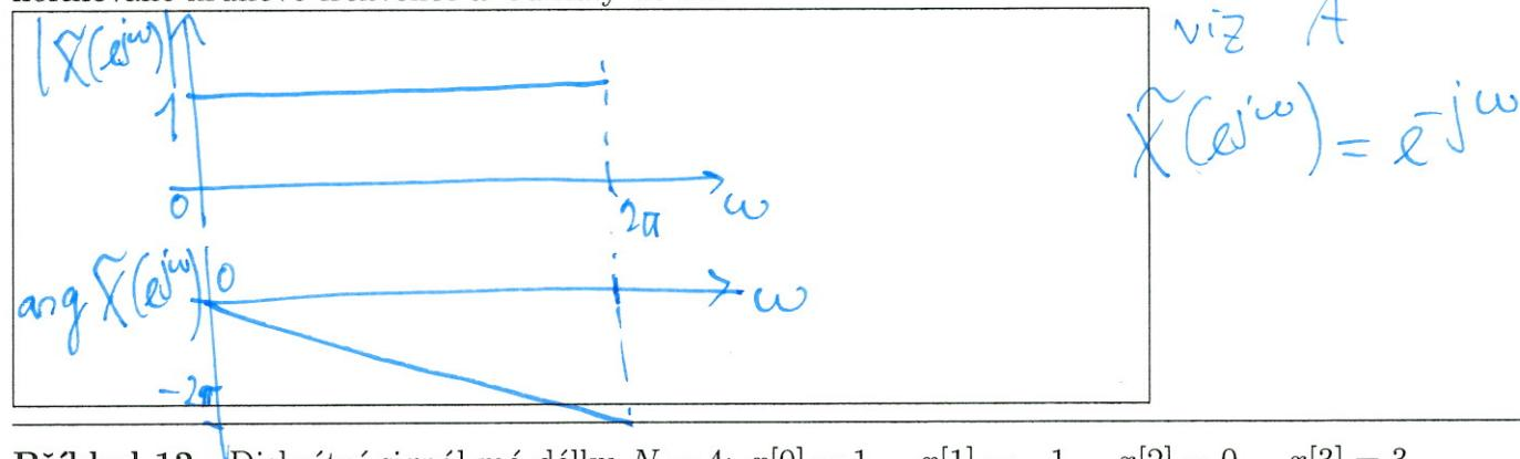
**Příklad 12** Diskrétní signál má délku  $N = 4$ :  $x[0] = 1, x[1] = -1, x[2] = 0, x[3] = 3$ . Vypočtěte zadaný koeficient jeho diskrétní Fourierovy transformace (DFT).
