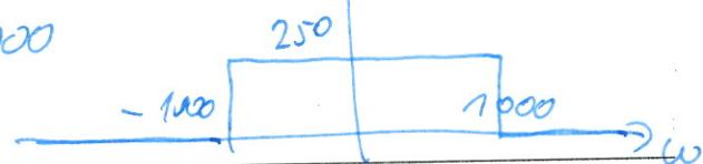
**Příklad 6** Signál je ideálně vzorkován na vzorkovací frekvenci  $F_s = 32$  kHz. Napište vztah pro impulsní odezvu ideálního rekonstrukčního filtru  $h_r(t)$  a nakreslete ji.
