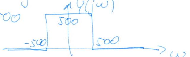
Příklad 6 Signál je ideálně vzorkován na vzorkovací frekvenci  $F_s = 32$  kHz. Napište vztah pro impulsní odezvu ideálního rekonstrukčního filtru  $h_r(t)$  a nakreslete ji.
