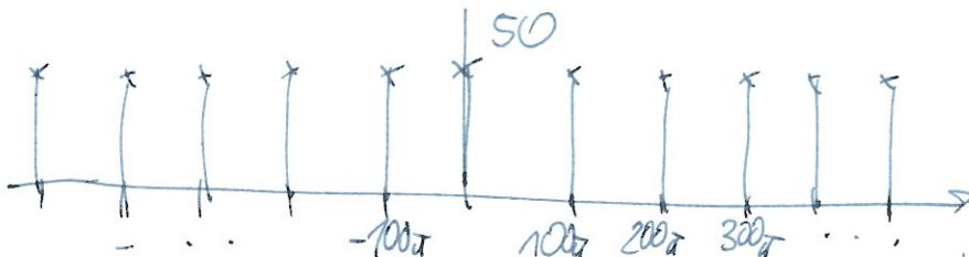
**Příklad 4** Spektrální funkce signálu se spojitým časem  $x(t)$  má na kruhové frekvenci  $\omega_1 = 200\pi$  rad/s hodnotu  $X(j\omega_1) = \sqrt{18}e^{j\frac{3\pi}{4}}$ . Určete hodnotu spektrální funkce předběhnutého signálu:  $y(t) = x(t + \frac{3}{200})$  na téže kruhové frekvenci. Hodnotu napište ve složkovém tvaru.
