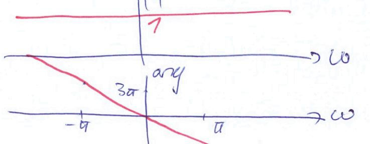
**Příklad 6** Spektrální funkce signálu  $x(t)$  má na kruhové frekvenci  $\omega_1 = 1000\pi$  rad/s hodnotu  $X(j\omega_1) = 1 + j$ . Určete, jakou hodnotu bude mít na stejné kruhové frekvenci spektrální funkce signálu  $y(t) = x(t - 0.003)$ .
