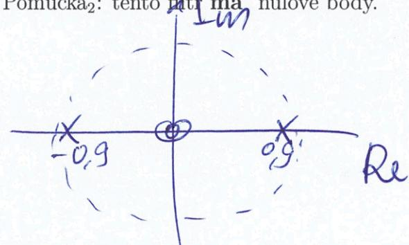
Příklad 18 Na obrázku jsou nulové body a póly číslicového filtru (v počátku je 12 pólů). Nakreslete přibližně modul jeho frekvenční charakteristiky  $H(e^{j\omega})$  pro interval normovaných kruhových frekvencí  $\omega$  od 0 do  $\pi$  rad.
