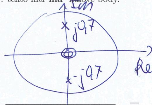
Příklad 18 Na obrázku jsou nulové body a póly číslicového filtru (v počátku je 12 pólů). Nakreslete přibližně modul jeho frekvenční charakteristiky  $H(e^{j\omega})$  pro interval normovaných kruhových frekvencí  $\omega$  od 0 do  $\pi$  rad.
