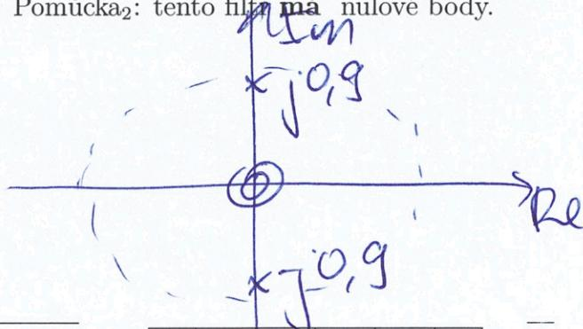
Příklad 18 Na obrázku jsou nulové body a póly číslicového filtru (v počátku je 12 pólů). Nakreslete přibližně modul jeho frekvenční charakteristiky  $H(e^{j\omega})$  pro interval normovaných kruhových frekvencí  $\omega$  od 0 do  $\pi$  rad.
