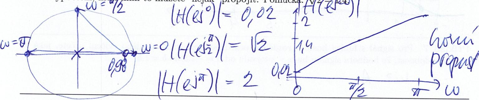
**Příklad 2** Určete hodnoty pólů číslicového filtru typu IIR s přenosovou funkcí:  $H(z) = \frac{1}{1 + 0.64z^{-2}}$  a rozhodněte, zda je tento filtr stabilní.
