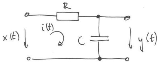
**Příklad 18** Přenosová funkce  $H(s)$  systému se spojitým časem má jeden nulový bod:  $n_1 = 0$  a dva póly:  $p_1 = -4 + 1000j$ ,  $p_2 = -4 - 1000j$ . Určete hodnotu frekvenční charakteristiky tohoto systému na kruhové frekvenci  $\omega_1 = 1000$  rad/s.
