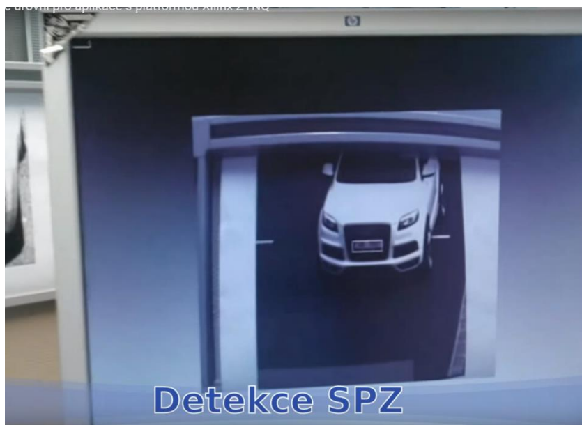
Obrázek 52: Vykreslovaná scéna na monitoru připojeného PC. V bílém rámečku je vyznačena detekce SPZ.
