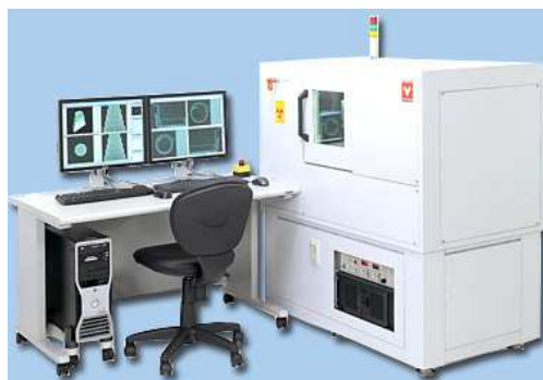
Obr.2.4.: Röntgenový skener, určený pre mikroskopické merania s presnosťou 1 \mu m. Prevzaté z [8].
