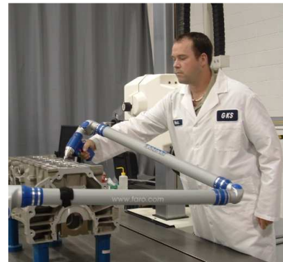
Obr.2.2: Skenovanie mechanickým 3D skenerom. Prevzaté z [2].
