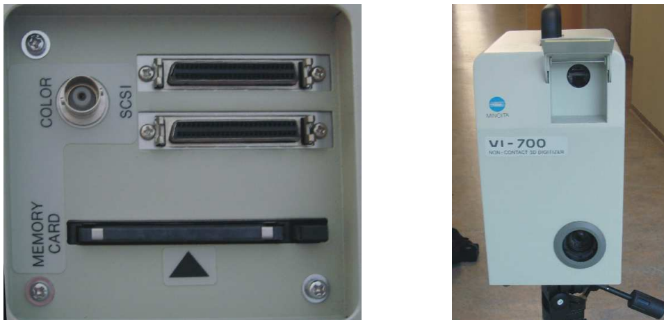
Obr.4.2.: Rozhrania skeneru (vľavo) a jeho optický snímač v dolnej časti a sklápacie dverka s laserom (vpravo).
