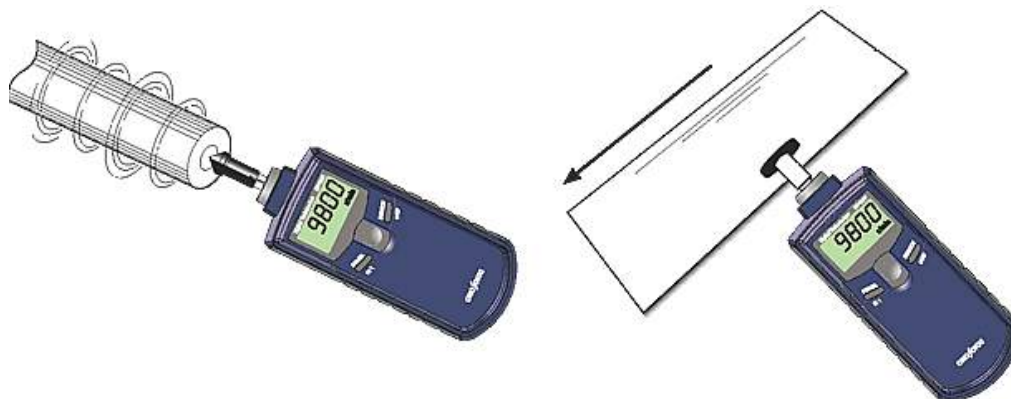
Obrázek 2.1: Kontaktní měření otáček. Vlevo - osa otáčení, Vpravo - obvodová rychlost. 1
