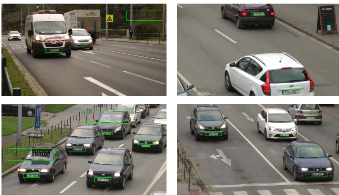
Obrázek 5.2: Detekce registračních značek pomocí kaskádového klasifikátoru.
