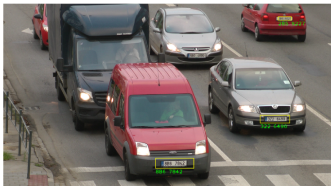
Obrázek 5.7: Ukázka výstupů celého systému detekce a rozpoznání registrační značky vozidel. Tyto výstupy obsahují chyby zapříčiněné špatným rozpoznáním symbolu, nenatrénováním daného znaku abecedy nebo nenalezením registrační značky.
