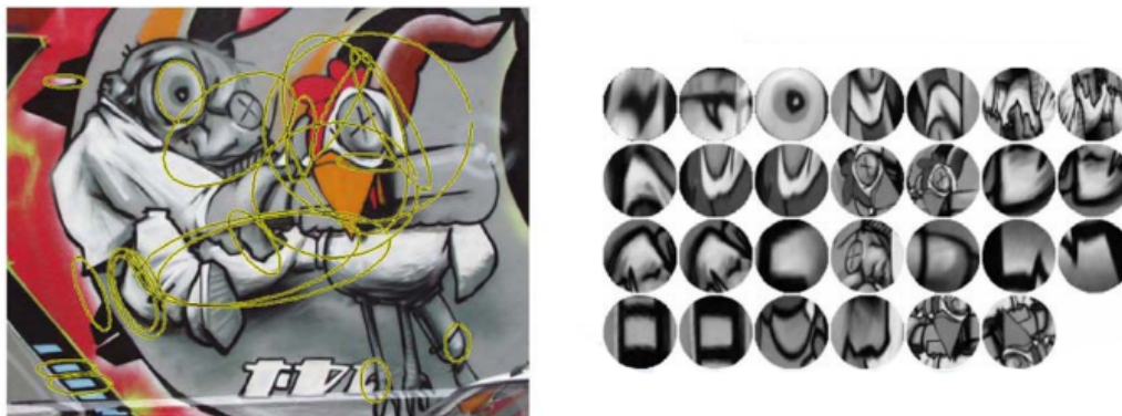
Obrázek 3.5: Ukázka výstupu MSER detektoru. Levý obrázek zobrazuje elipsy aproximující k nalezeným regionům. Pravý obrázek zobrazuje detail na elipsy nalezených MSER regionů.
