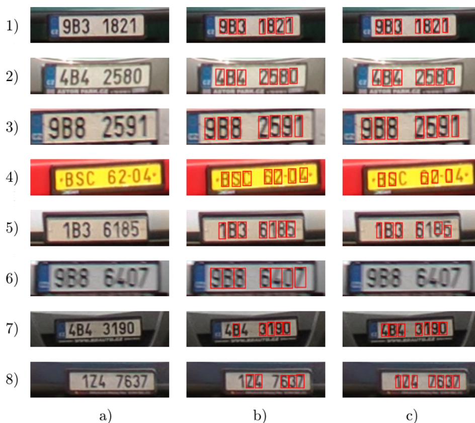
Obrázek 5.4: Nalezení pozic písmen. Sloupec a) obsahuje originální výřez registrační značky. Ve sloupci b) jsou znázorněny výstupy pomocí detekce MSER regionů. Sloupec c) obsahuje výstup pomocí hledání blobů. V řádcích 1-3) jsou zobrazeny správné výstupy obou metod. V řádcích 4-6) je vidět, že metoda detekce blobů nefunguje správně. Ve zbývajících řádcích 7-8) jsou špatně nalezeny pozice metodou detekce MSER regionů.
