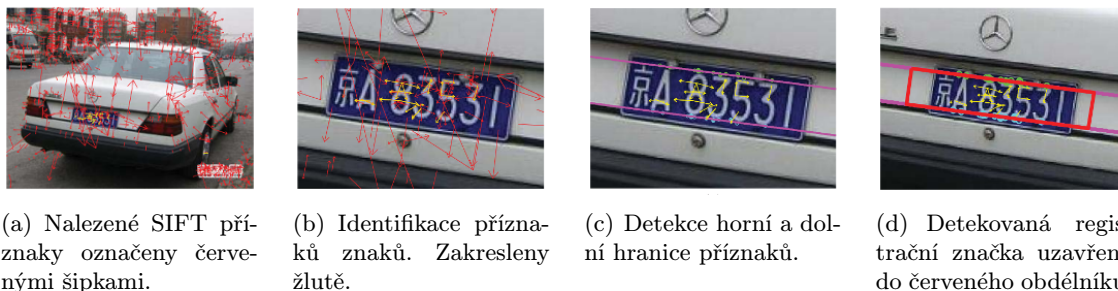
Obrázek 2.11: Ukázka nalezení registrační značky pomocí extrakce SIFT příznaků. Převzato z [23].
