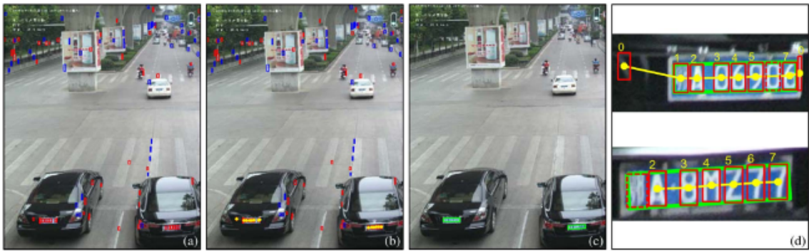
Obrázek 2.8: Ukázka detekce registrační značky: Detekce kandidátních oblastí (a). Konstrukce CRF (b). Výsledek detekce registrační značky (c). Přibližovaná registrační značka (d). Kandidátní znaky jsou označeny červenými a modrými obdélníky. Žluté tečky a čáry označují uzly a vazby na CRF. Zelený obdélník obaluje nalezenou registrační značku. Převzato z [12].
