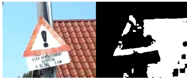
Obr. 4.3: Splynutie značky s pozadím a vytvorenie binárnej mapy.
