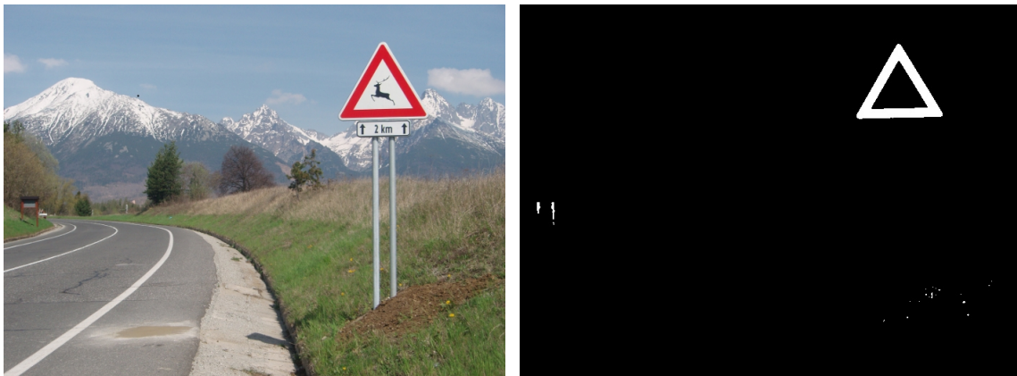
Obr. 1.3: Pôvodny RGB obraz a Binárna mapa po RGB prahovaní.
