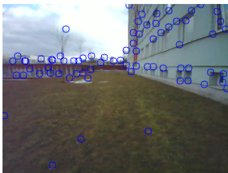
Obrázek 5.3: Rohy vhodné ke sledování metodou optického toku.
