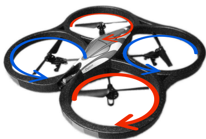
Obrázek 2.1: AR.Drone s krytem pro létání uvnitř budov. Naznačeny jsou směry otáčení vrtulí kvadrokoptéry.
