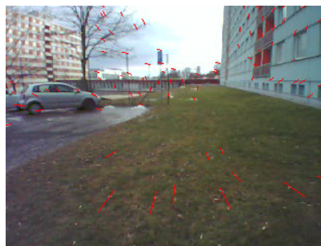
Obrázek 5.4: Příklad vektorů optického toku.
