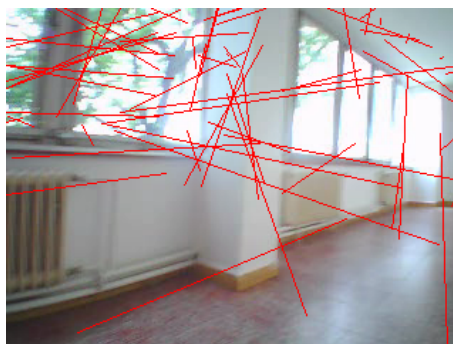
Obrázek 5.5: Ukázka selhání výpočtu optického toku způsobená rychlým otočením kamery.
