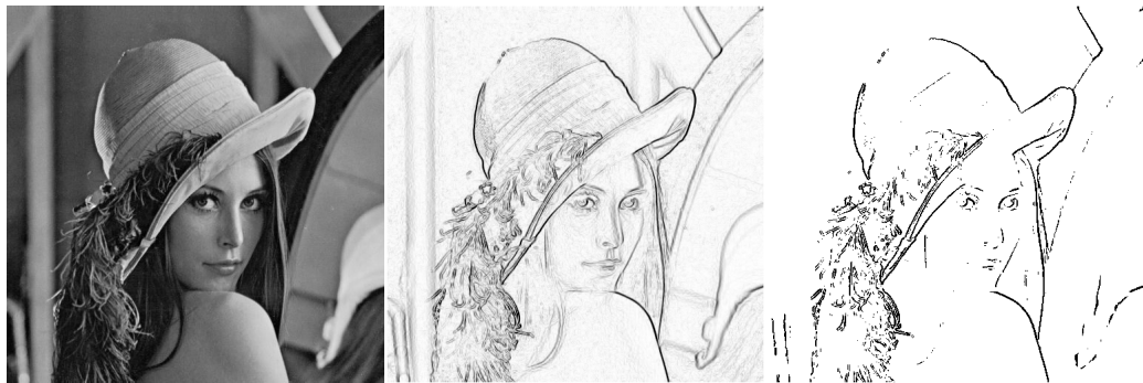
Obrázek 5.2: Vlevo původní obrázek. Uprostřed detekce hran pomocí Sobelových operátorů. Vpravo výsledek po prahování, kde T = 42 .
