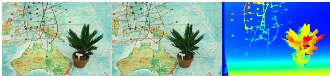
Obr. 5.4: Ukážka výstupu metódy MC-CNN-acrt. Obrazy zľava: ľavý vstupný obraz, pravý vstupný obraz, disparitná mapa (výstup metódy). Zdroj: http://vision.middlebury.edu/stereo/eval3/ .
