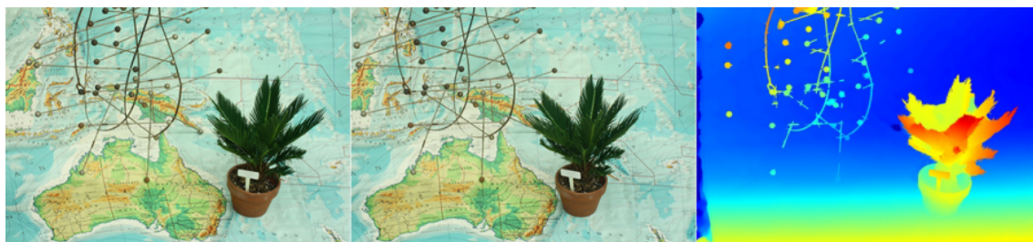
Obr. 5.3: Ukážka výstupu metódy MeshStereoExt. Obrazy zľava: ľavý vstupný obraz, pravý vstupný obraz, disparitná mapa (výstup metódy). Zdroj: http://vision.middlebury.edu/stereo/eval3/ .
