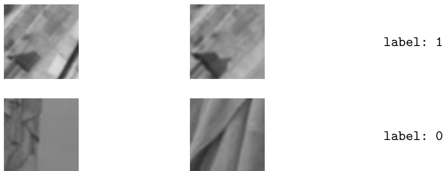
Obr. 8.2: Ukážka anotovaných dvojíc, ktoré som použil pri tréovaní a testovaní neurónovej siete. Vizálne podobné obrázky som radil do triedy 1, rozdielne do triedy 0.
