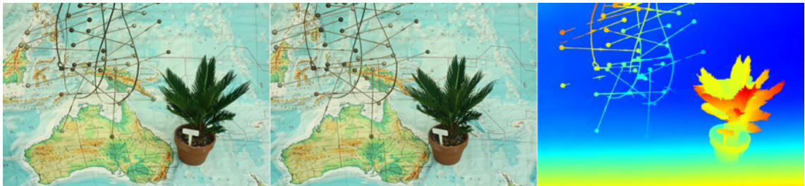
Obr. 5.1: Ukážka výstupu metódy PMSC. Obrazy zľava: ľavý vstupný obraz, pravý vstupný obraz, disparitná mapa (výstup metódy). Zdroj: http://vision.middlebury.edu/stereo/eval3/ .
