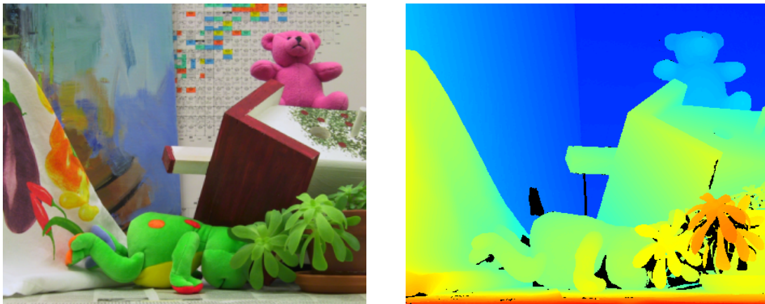
Obr. 3.3: Vstupný obraz z ľavej kamery a vzorová disparitná mapa (ground truth) prislúchajúca danému vstupu [23].
