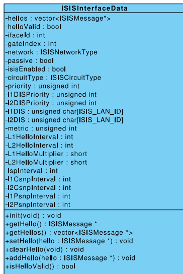
Obrázek 4.2: Class diagram IS-IS
