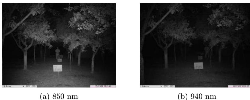
Obrázek 2.2: Srovnání IR přísvisu diod s různou vlnovou délkou [21]
