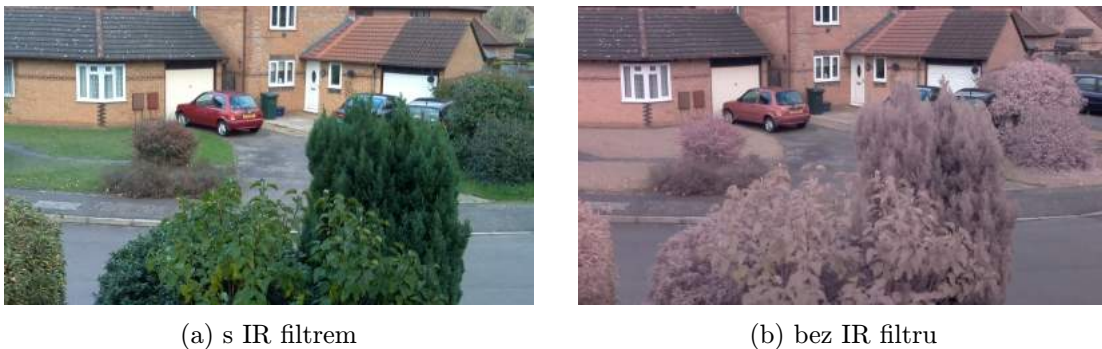
Obrázek 3.6: Porovnání fotografií z kamer s IR a bez IR filtru za denního světla [7]
