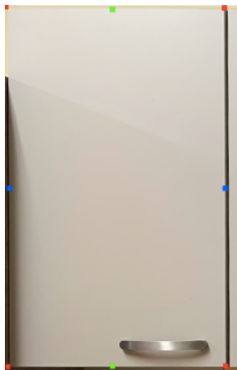
Obrázek 3.6: Ilustrační obrázek bodů sloužících k výpočtu velikosti. Červeně jsou znázorněny známé rohové body. Zeleně horizontální středové body. Modře vertikální středové body.
