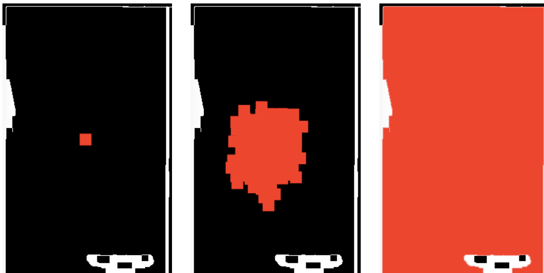
Obrázek 4.2: Ilustrace floodFill algoritmu.
