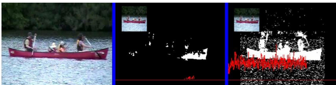
Obr. 42: Detekce objektů s dynamickým pozadím – vlevo originalní snímek, uprostřed výstup ViBe, vpravo výstup SDG
