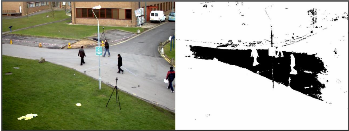
Obr. 5: Příklad oblastí duchů – bílé plochy na obrázku vpravo špatně vyhodnoceny jako pohyb, jelikož tato konkrétní videosekvence obsahuje pohybující se objekty již při prvním snímku. Tyto oblasti s postupem času přechází do pozadí.
