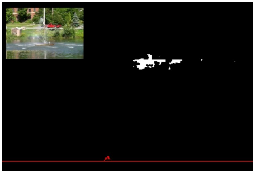
Obr. 37: Odstranění pohybu způsobeného fontánou a detekce automobilu v pozadí
