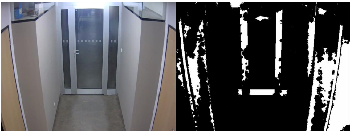
Obr. 18: Výstup algoritmu ViBe 5 vteřin po bliknutí světla ( noMin=2 )
