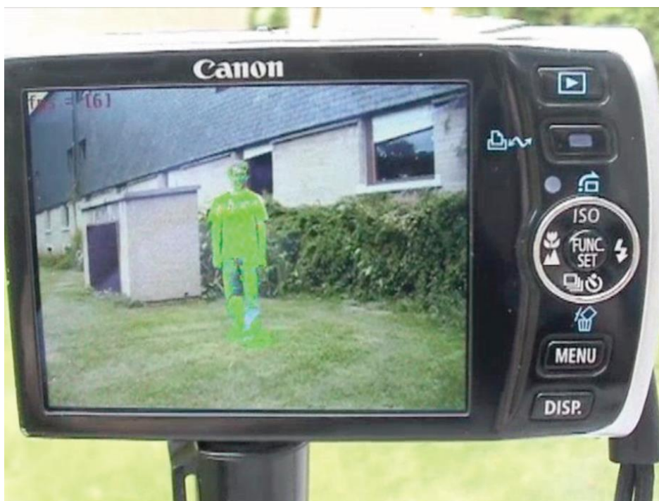
Obr. 7: Konkrétní použití algoritmu ViBe u fotoaparátu značky Canon. Algoritmus v reálném čase automaticky detekuje popředí (které je v tomto případě označeno zelenou barvou).
