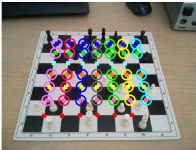
Obr 5.5 – ukážka detekovaných priamok; bodové značenie pre priamky poľa č. 1, kružnicové značenie pre priamky poľa č. 2
