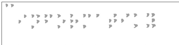
Obrázek 6.3: Výsledný obrázek po semínkovém vyplňování. Obrázek obsahuje pouze skupiny, které jsou považovány za tečky, a zbylý šum je ze snímku odstraněn.
