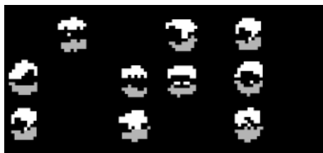
Obrázek 4.5: Ukázka detekce braillofských znaků pomocí tří barevných složek.
