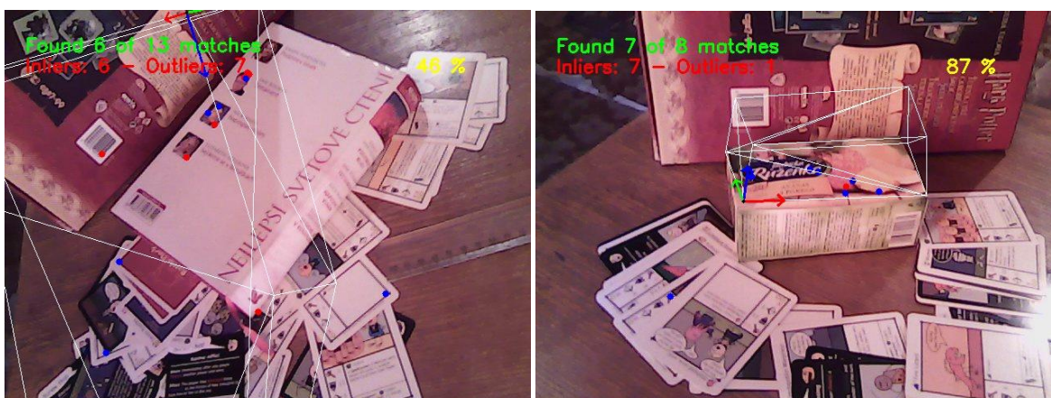
Obrázek 7-3: Špatně odhadnutá pozice Knihy (vlevo) a Krabice (vpravo).
