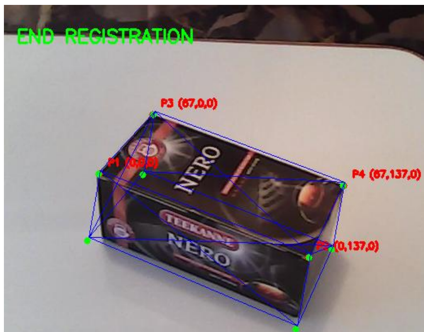
Obrázek 6-1: Registrace, vložení modelu pomocí 4 bodů.
