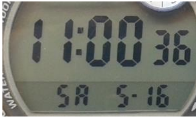
Obrázek 2.1 – Segmentový LCD displej náramkových hodinek
