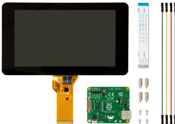
Obrázek 3.7: Oficiální displej k Raspberry Pi. Převzato z [10]
