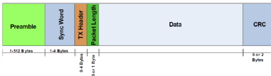
Obrázek 3- Struktura paketu RF modulu [5]
