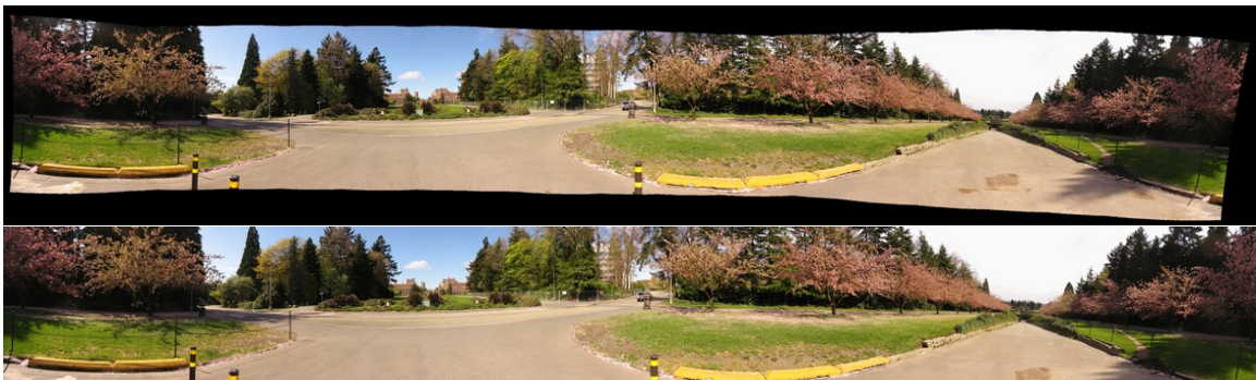
Obrázek 6.15: Sférické panorama trees z 18 snímků a jeho výřez. Ohnisková vzdálenost 649px korekce radiálního zkreslení k_1 = -0.15 a k_2 = 0 . Klíčové body metoda SURF. Hodnocení mean = 24.18 , max = 64.71 a min = 9.98 .
