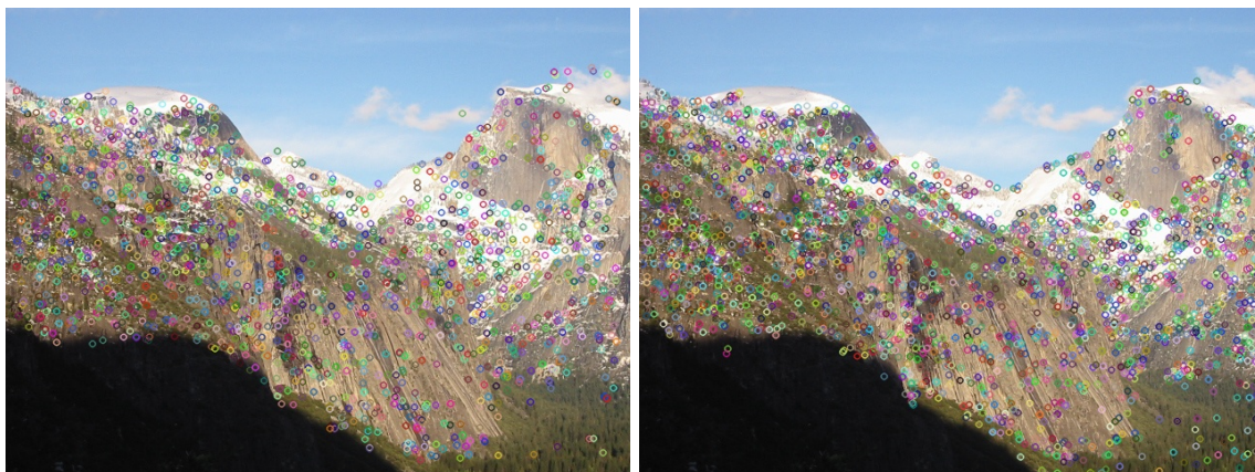
Obrázek 5.4: Ukázka nalezených klíčových bodů ve snímku yosemite1 (sada na obrázku 3.1) v perspektivní projekci. V levém snímku metodou SURF a v pravém metodou SIFT.
