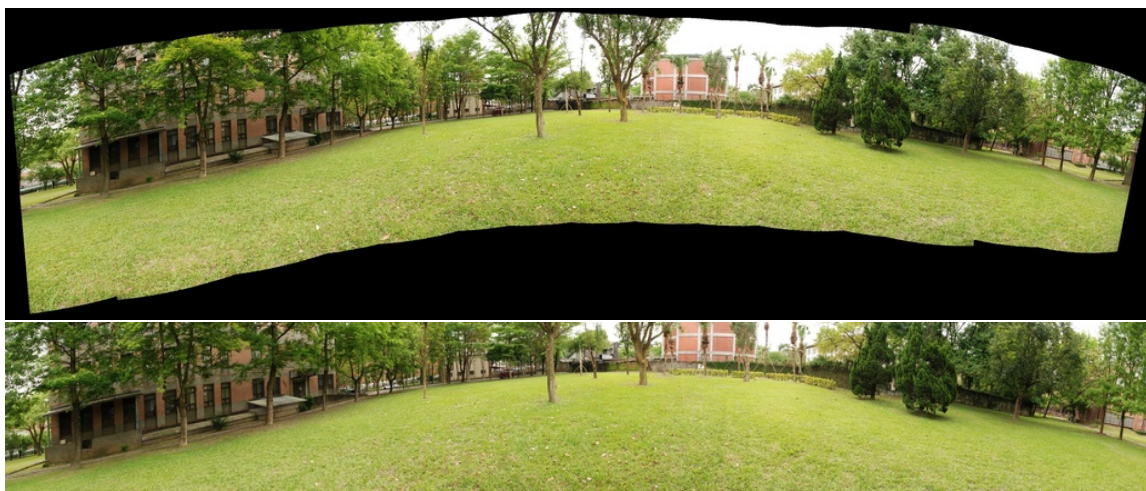
Obrázek 6.12: Cylindrické panorama grass z 17 snímků a jeho výřez. Ohnisková vzdálenost 673px korekce radiálního zkreslení k_1 = 0 a k_2 = 0 . Klíčové body metoda SURF. Hodnocení mean = 27.97 , max = 40.51 a min = 18.27 .
