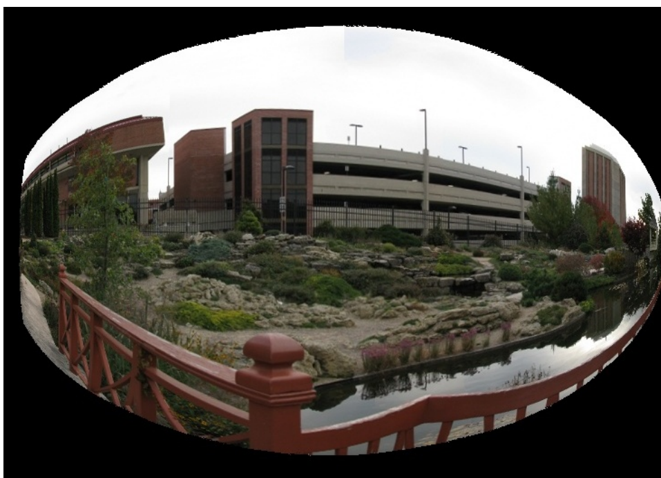
Obrázek 6.19: Sférické panorama z 12 snímků park z datové sady [29]. Ohnisková vzdálenost byla nastavena na hodnotu 300px což je dvakrát méně než je správná hodnota. Korekce radiálního zkreslení k_1 = -0.22892 a k_2 = 0.27797 dle [29]. Výsledek je silně zkreslen připomíná výstupy z objektivů typu rybí oko. Klíčové body metoda SURF. Hodnocení mean = 16.73 , max = 23.41 a min = 12.48 .
