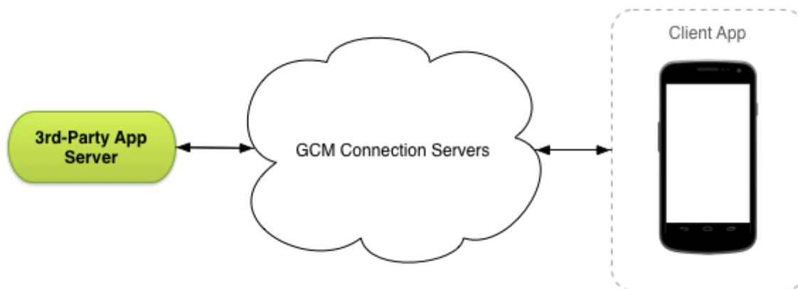
Obrázek 7 Schéma komunikace přes GCM, Zdroj [11]
