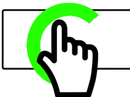
Obrázek 6.4: Selektce tlačítka v menu ukazovacím způsobem - při najetí prstem do prostoru tlačítka se spustí časovač znázorněný vyplňujícím se kolečkem. Po jeho doběhnutí se potvrdí výběr.
