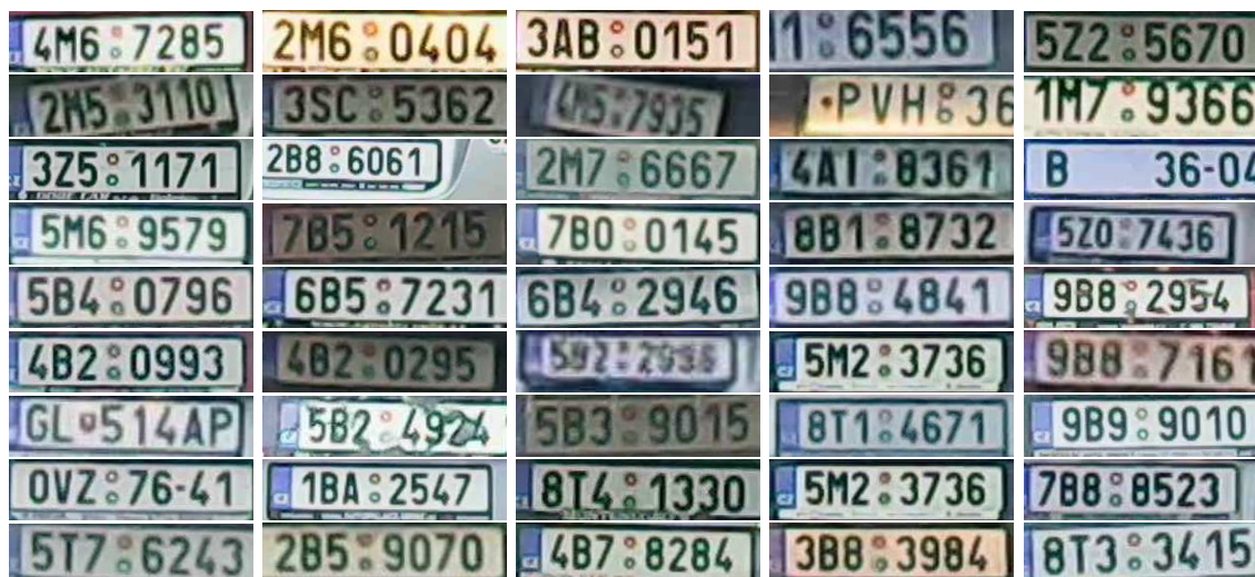
Obrázek 4.1: Ukázka datové sady registračních značek získaných pomocí aplikace frames2licensePlate ze záběrů „on-board“ kamery, umístěné na čelním skle vozidla. Registrační značky získané touto metodou se vyznačují různými rozměry, světlými podmínkami i rozlišením, v závislosti na vzdálenosti detekované registrační značky.
