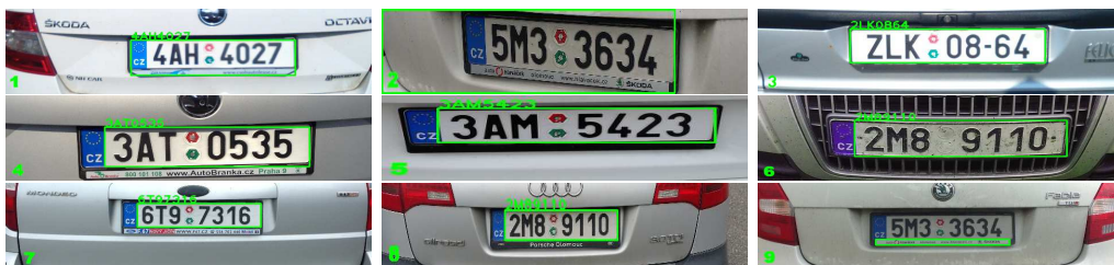
Obrázek 4.9: Ukázka výstupu detekce registrační značky pomocí vyhledávání klíčových bodů a její rozpoznání s využitím metody template matching . Na obrázcích 2 a 9 je vidět selhání detektoru registračních značek. Obrázek 3 potom zobrazuje chybné rozpoznání písmena Z, kdy byla jako více odpovídající zvolena číslice 2.
