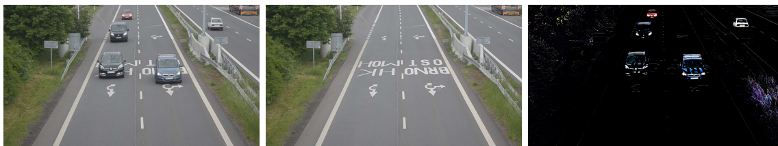
Obrázek 3.9: Ukázka metody rozdílů snímků. (Vlevo) Zpracovávaný snímek videa. (Uprostřed) Statický snímek pozadí. (Vpravo) Výsledný snímek po odečtení. Upraveno pro lepší viditelnost segmentovaných objektů.
