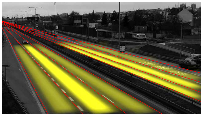
Obrázek 3.4: Ukázka přesné segmentace metody detekce jízdních pruhů z automatického systému kalibrace kamery pro analýzu dopravy. Obrázek byl převzat ze článku [5]
