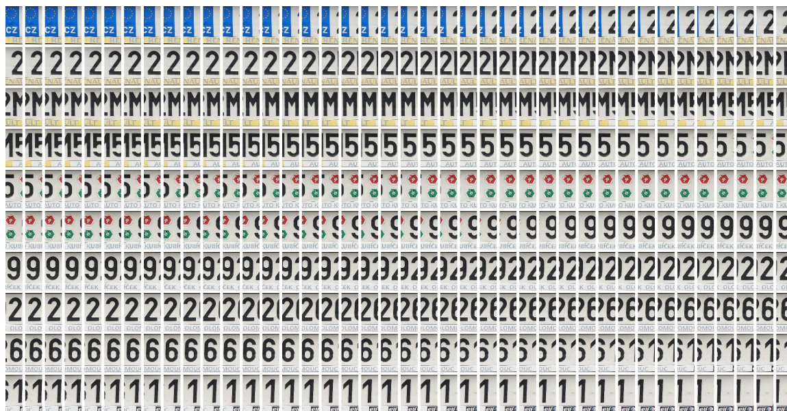
Obrázek 4.3: Ukázka RZ 2M5 9261, rozdělená pomocí skenování sliding window na jednotlivé segmenty. Každý z těchto segmentů je poté použit na trénování neuronové sítě.
