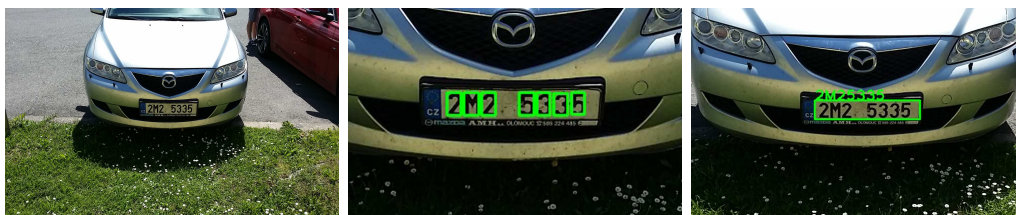
Obrázek 4.8: Ukázka principu rozpoznání registrační značky vozidla pomocí metody template matching . (Vlevo) Vstupní snímek pro detekci a rozpoznání. (Uprostřed) Detekované znaky uvnitř detekované registrační značky. (Vpravo) Výsledek rozpoznání registrační značky společně s detekovanou oblastí registrační značky.
