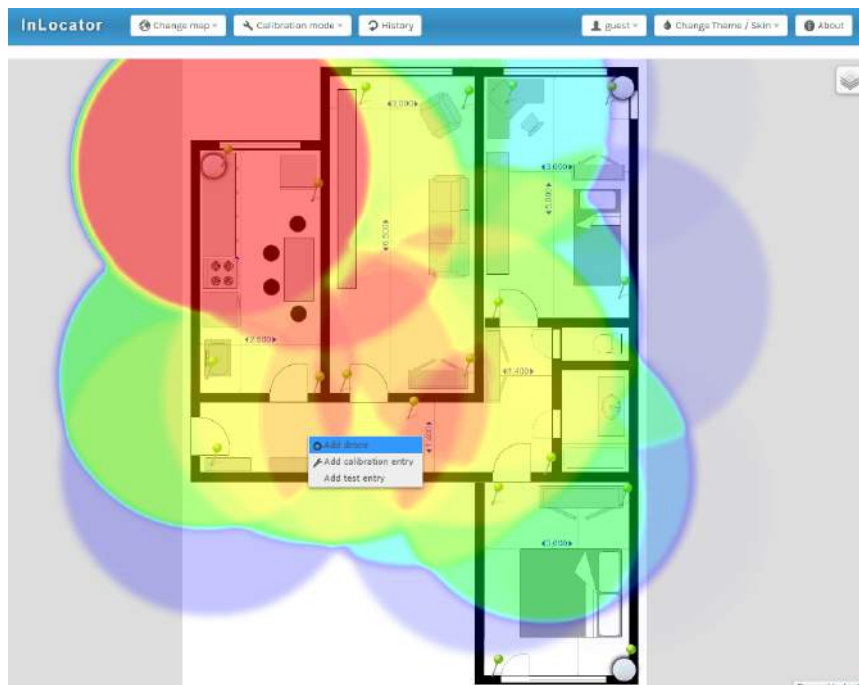
Obrázok D.3: Snímka obrazovky zobrazujúcej jednotlivé kalibračné body, intenzitu nameraného signálu voči zvolenej sonde v kalibračnom móde a kontextové menu aplikácie
