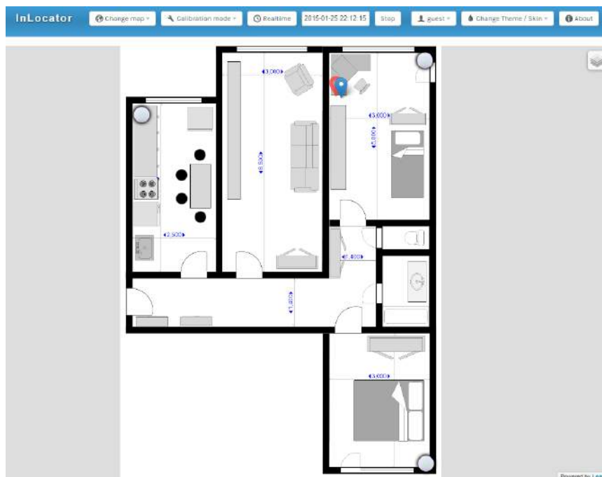
Obrázok D.2: Snímka základnej obrazovky zobrazujúcej mapu monitorovanej budovy a polohu lokalizovaných zariadení
