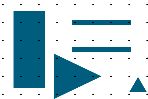
Obrázek 2.1: Vektorová reprezentace, černými tečkami jsou označeny středy pixelů pro rasterizaci.
