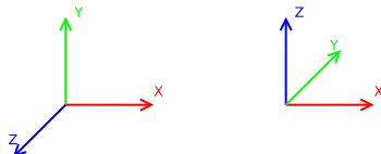
Obrázek 5.2: Uspořádání souřadnicových os používaných ve WPF a 3DsMAX
