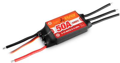
Obrázek 4.3: Regulátor RAY R-50SB. Obrázek převzat z [14].
