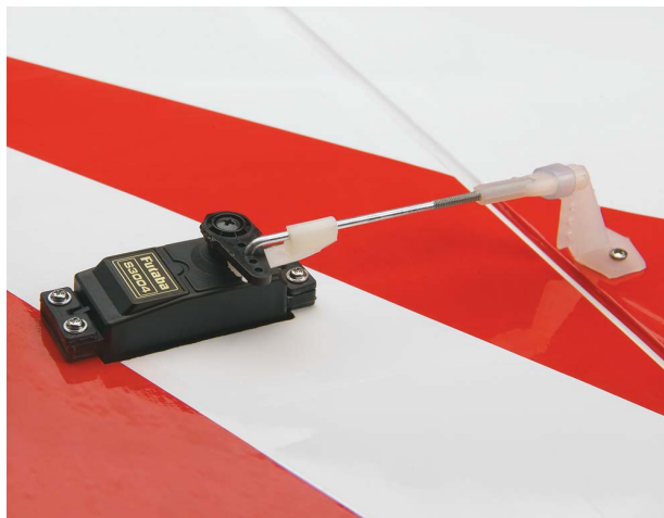
Obrázek 4.4: Servo, které je propojené tahýlkem ke křídélku. Obrázek převzat z [18].
