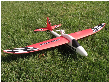
Obrázek 2.1: Cvičný model Wild Hawk [15] vyrobený z odolného EPP materiálu.
