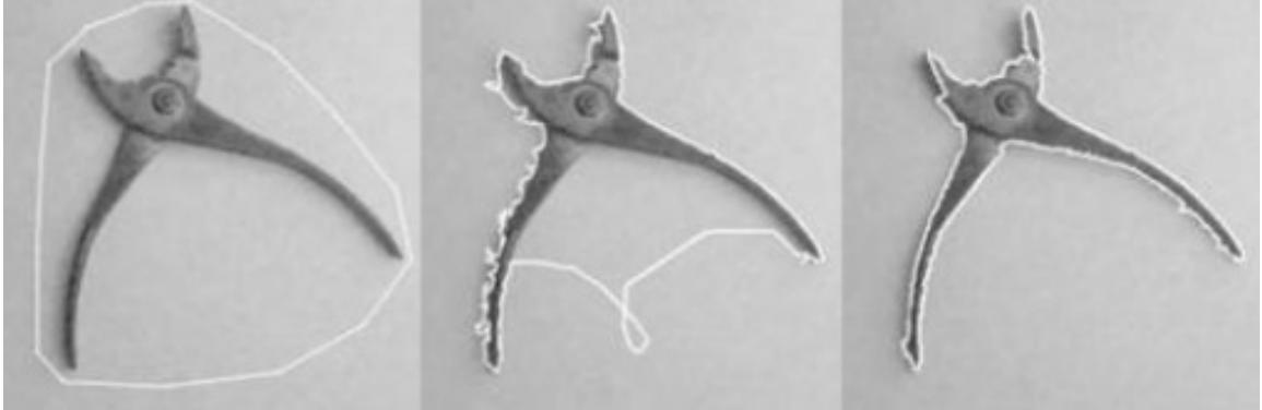
Obrázek 3.2: Tvarování aktivní kontury - zleva počáteční stav, standardní postup a modifikovaná verze algoritmu. [27]
