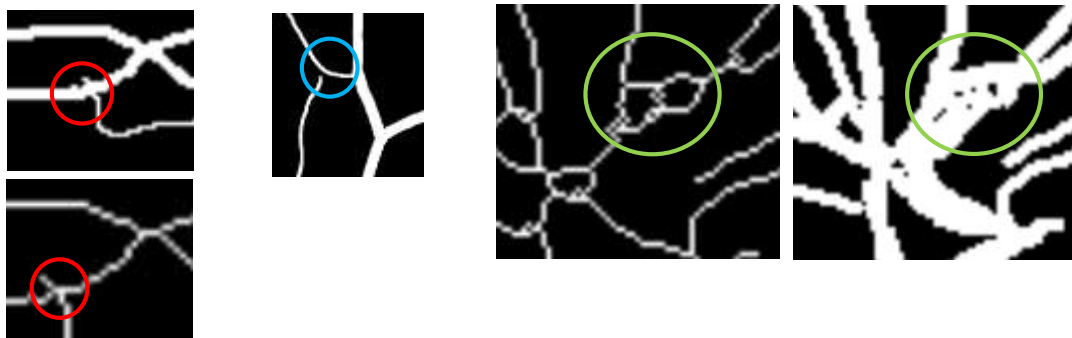
Obrázek 5.9 – chyby manuálně segmentovaného řečiště – (zleva) vyčnívající pixel, nespojené cévy a černé pixely uprostřed cév
