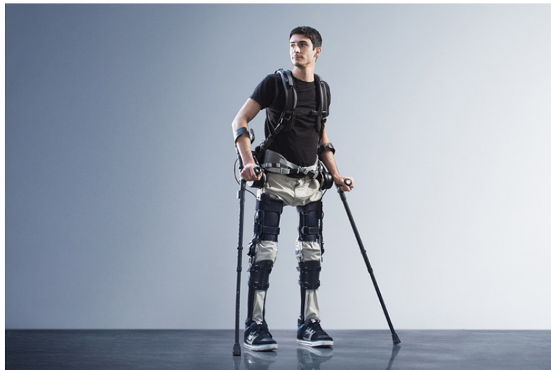
Obrázek 3.6: Nositelný exoskeleton, který je vyvíjen výzkumníky z UC Berkley a má umožnit ochrnutým lidem znovu chodit. Na obrázku je Steven Sanchez, který ochrnul po nehodě na BMX. (Zdroj: [113])
