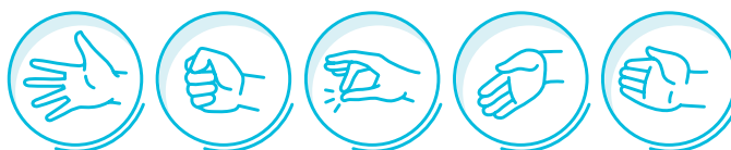
Obrázek 4.3: Základní gesta detekovatelná zařízením Myo armband. Zleva: Fingers Spread , Fist , Double Tap , Wave Left a Wave Right . (Zdroj: [22])
