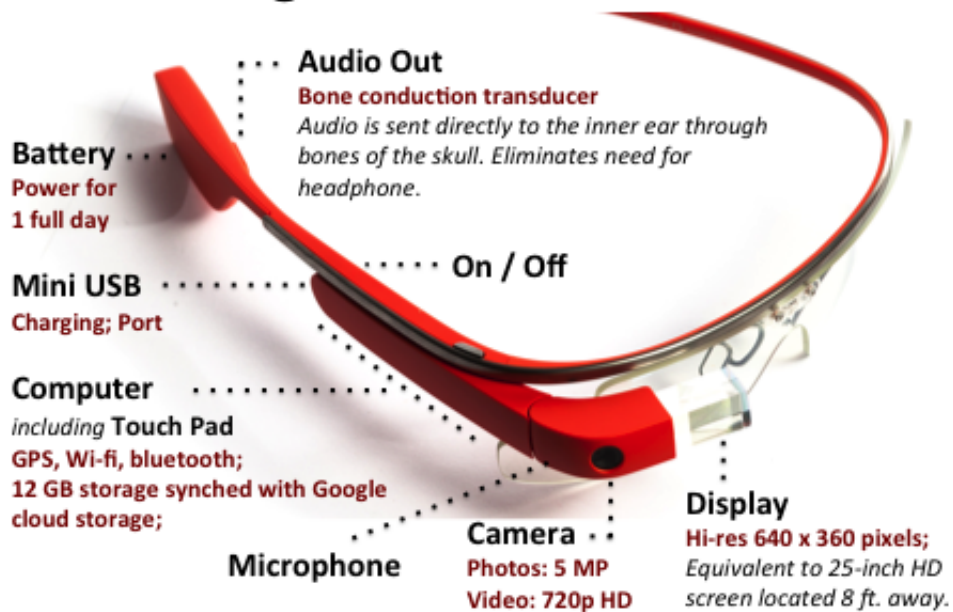
Obrázek 2.7: Google Glass a popis jejich jednotlivých částí (Zdroj: [29])
