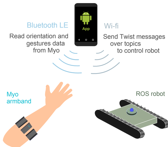
Obrázek 4.1: Architektura systému (popisuje komponenty a způsob komunikace).
