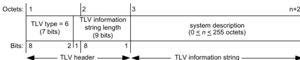
Obrázek 3.9: Formát system description TLV.
