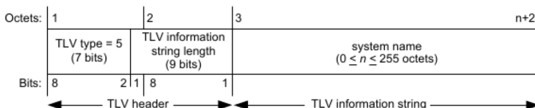
Obrázek 3.8: Formát system name TLV.
