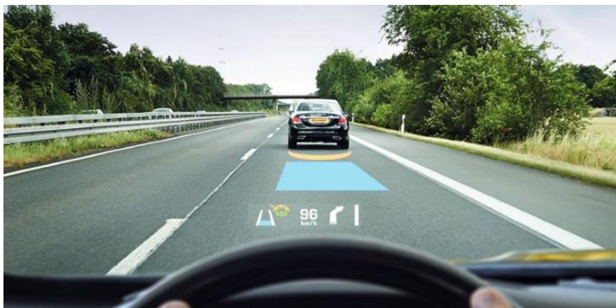
Obrázok 2.1: Head-up displej v automobile
