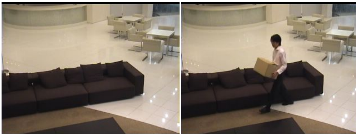
Obrázek 3.5: Vlevo je znázorněn snímek, který by mohl být určen jako pozadí. Snímek vpravo je aktuální snímek, na kterém se vyskytuje pohyb člověka a bude tedy posouzen jako snímek popředí.
