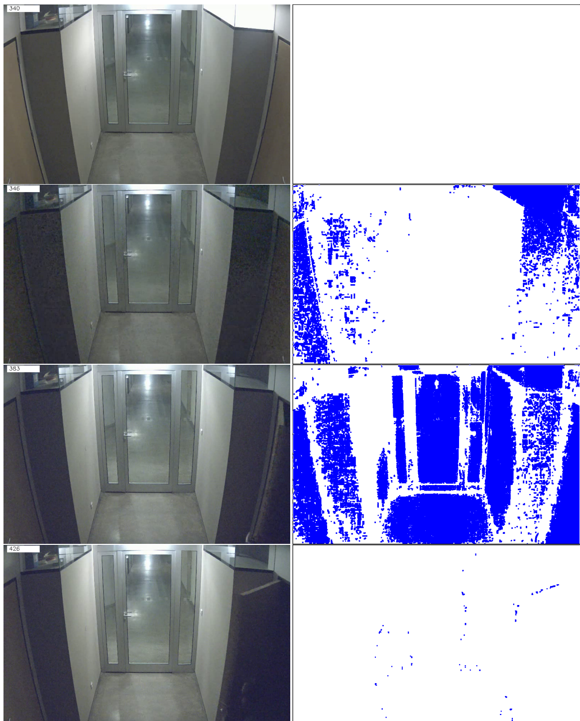
Obrázek 4.8: Znázornění reakce na zhasnutí světla. První snímek je 340. v pořadí, na kterém je vidět v pravém horním rohu rozsvíceno. Na dalším snímku s pořadovým číslem 346 je již světlo zhasnuté a tato změna se začíná algoritmem projevovat. Největší intenzita se vyskytuje okolo snímku 383 a zotavení se z této události dochází částečně až na snímku 426.
