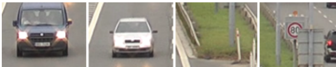
Obrázek 2.1: Levé dva obrázky jsou pozitivní prvky, tedy prvky které obsahují hledaný objekt. Pravé dva obrázky potom představují prvky negativní, tedy prvky které obsahují buď pouze část hledaného objektu nebo jiné objekty.
