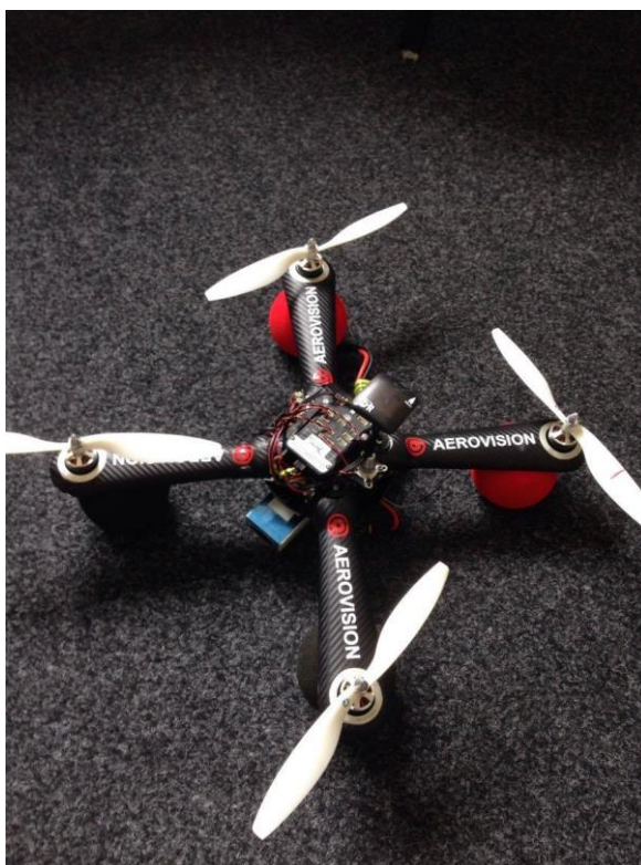
Obr. 7.4.1: Dron s řídicí jednotkou Pixhawk
