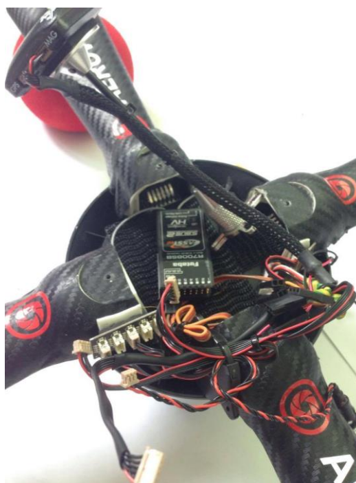
Obr. C.3: Propojení motorů a připravená kabeláž pro řídicí jednotku
