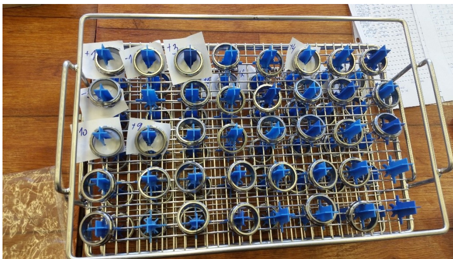
Obr. 2.2: roztriedenie krúžkov podľa rozmerov
