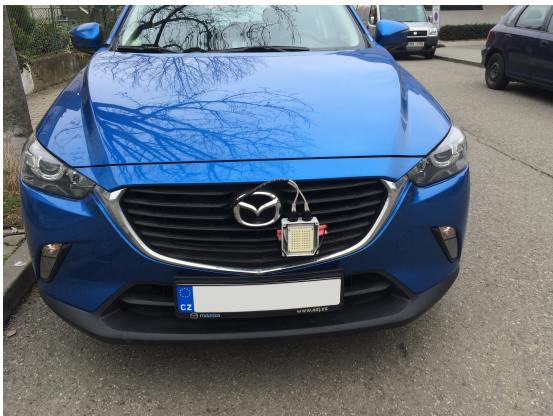
Obrázek 7.4: Vozidlo s instalovaným K-MC4 radarovým modulem.
