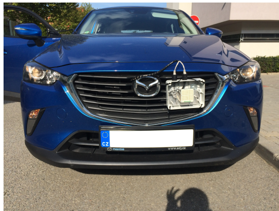
Obrázek 7.5: Vozidlo s instalovaným IVS-948 radarovým modulem.
