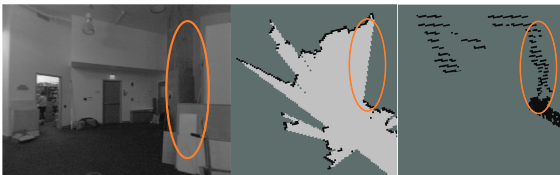
Obrázek 5.4: Scéna s bariérou - zdrojový obrázek vlevo, mapa z LIDARu uprostřed, mapa z kamery vpravo.
